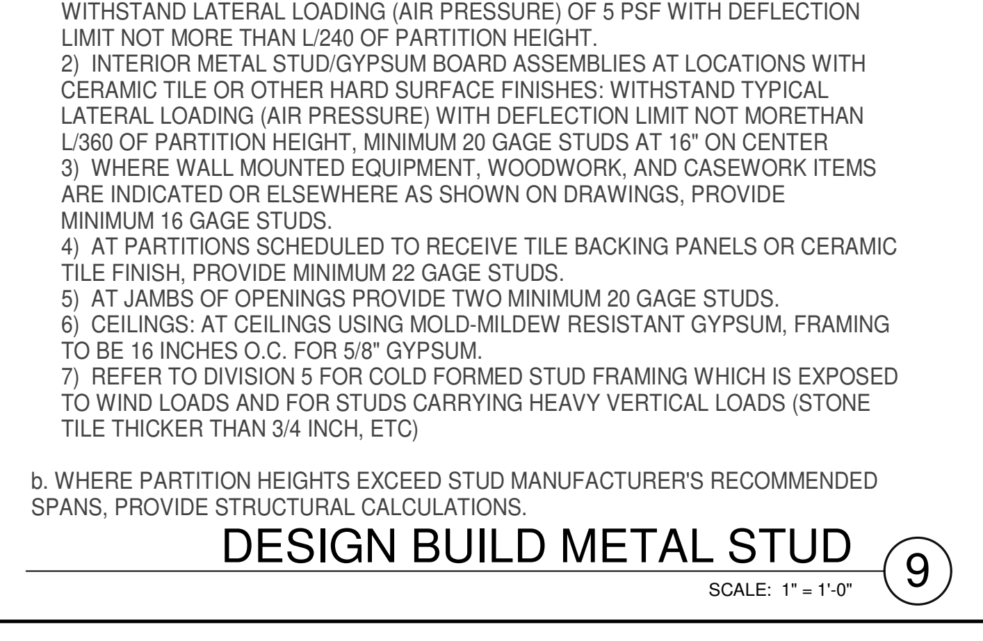
DESIGN BUILD METAL STUD SCALE: 1" = 1'-0" (9)
